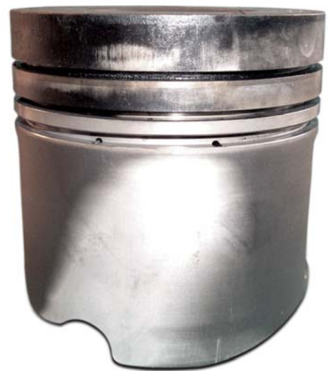
Abb. 1 Unsymmetrisches Tragbild (Schieflauf) am Kolbenschaft
