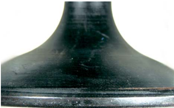
Abb. 1 Deformierter Ventilteller (Tulpenform)
