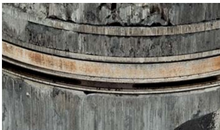
Abb. 2 Riefen und brandige Stellen an Kolbenringen
