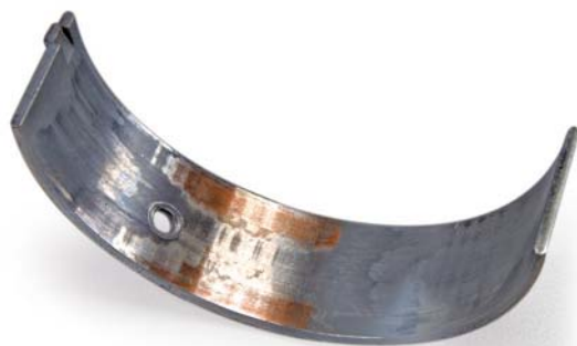
Abb. 1 Ungleichmäßiger Verschleiß an den Lagerschalen, Laufschicht zum Teil abgetragen
