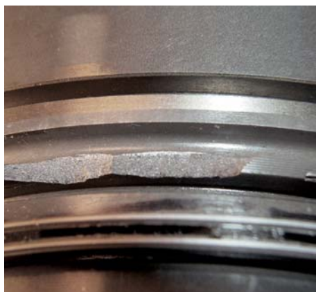
Abb. 2 Gebrochene Kolbenringstege durch Montagefehler
