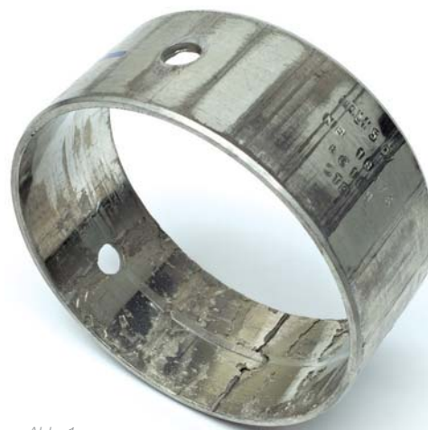
Abb. 1a Materialausbrüche, hervorgerufen durch mechanische Überlastung oder zu geringe Tragfähigkeit des Ölfilms
