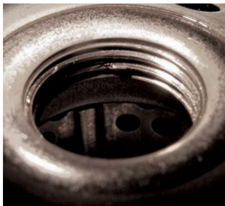
Abb. 5 Beschädigte Gewindegänge aufgrund eines schräg angeschraubten Filters
