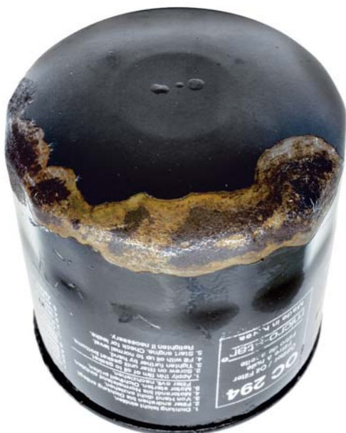
Abb. 4 Beschädigte Beschichtung – die Folge: Korrosion
