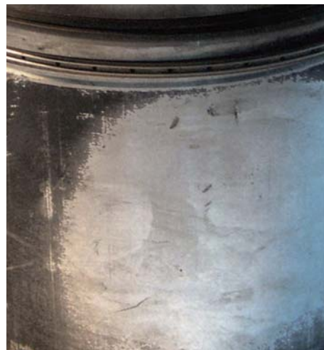
Abb. 1 Breites Tragbild und Riefen durch Kraftstoffverdünnung
