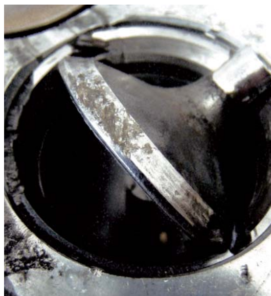
Abb. 1 Im Bereich des Ventiltellers abgerissenes Ventil
