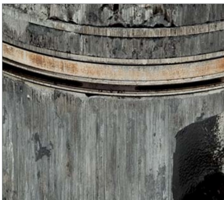
Abb. 2 Kolbenringe mit brandigen Stellen
