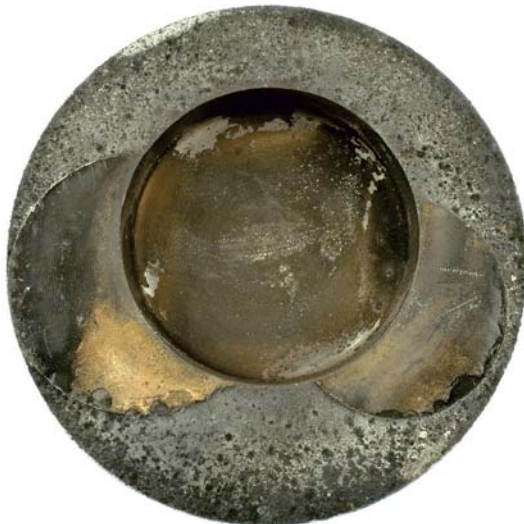
Abb. 2 Gegen Zylinderkopf gelaufener Kolben
