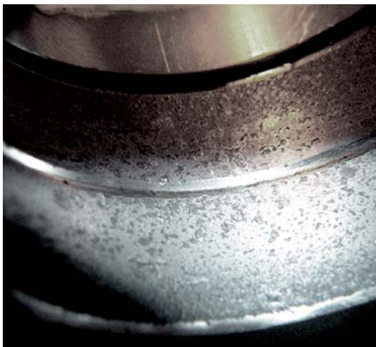
Abb.4b In der Vergrößerung noch deutlicher sichtbar: die Pittings
