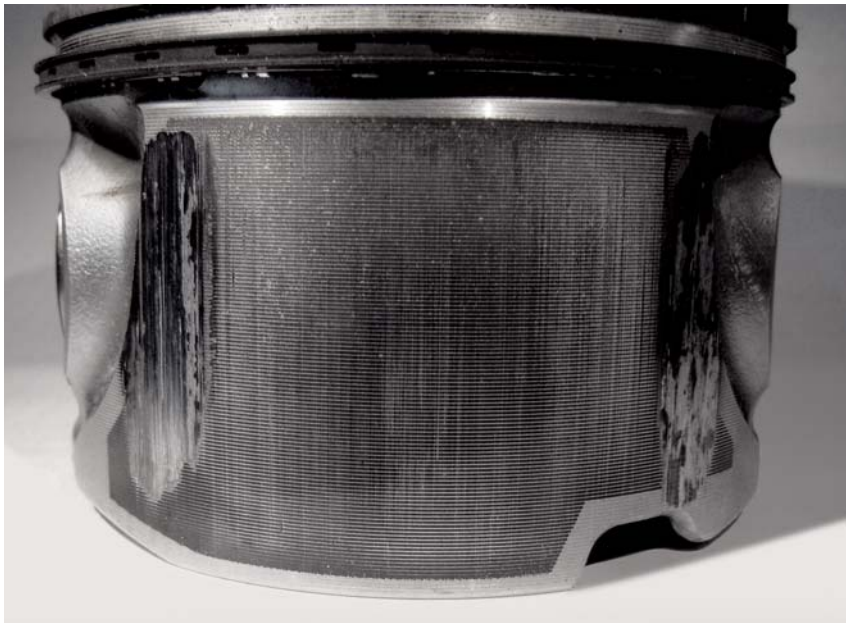
Abb. 2 Seitliche Kolbenfresser neben der Nabenbohrung
