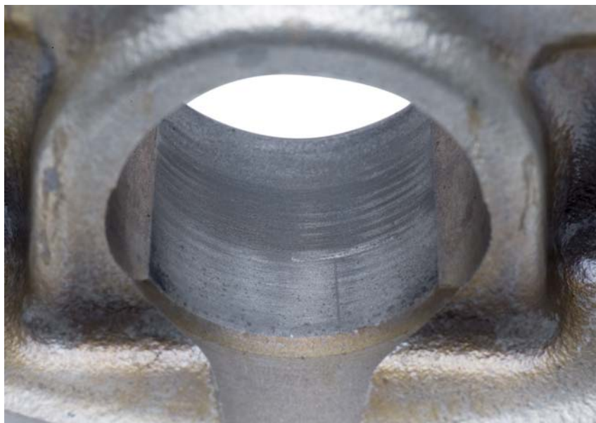
Abb. 1 Fresser in der Nabenbohrung
