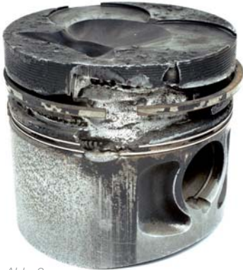
Abb. 2 Kolbenringzone mit blanker Oberfläche
