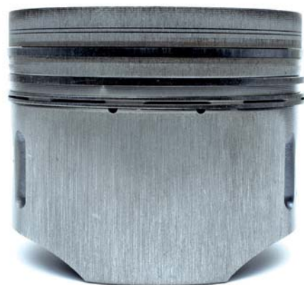
Abb. 1 Schmutzverschleiß am Kolben – starke Riefen in Längsrichtung
