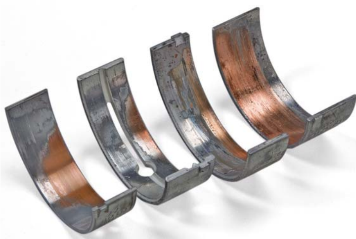
Abb. 1 Ungleichmäßiger Verschleiß an den Pleuellagern
