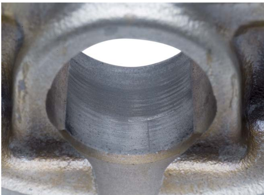
Abb. 3 Nabenbohrung mit Fressspuren
