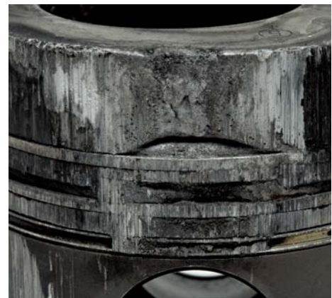
Abb. 1 Abschmelzungen am Feuersteg eines Dieselpistons
