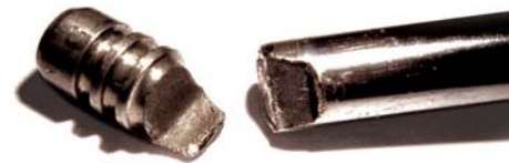
Abb. 2 In der Rille gebrochener Ventilfuß (Gewaltbruch/Biegebeanspruchung)
