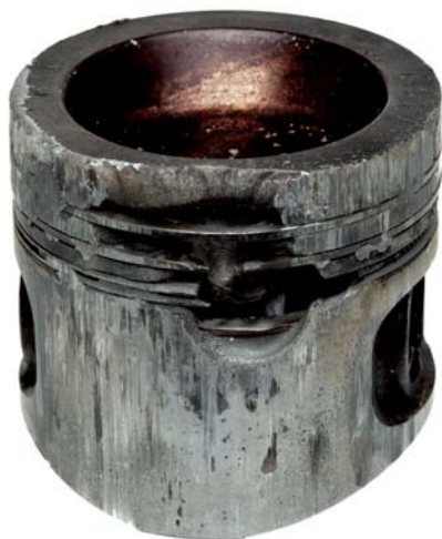
Abb. 2 Abgeschmolzener Feuersteg am Ottokolben
