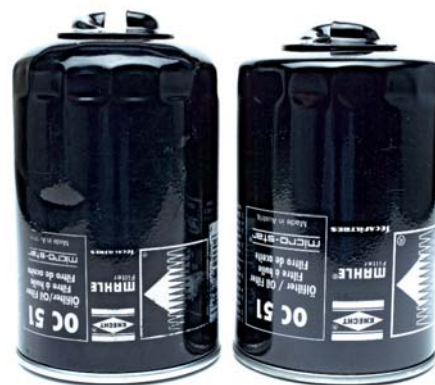
Abb. 2 Im Vergleich: aufgeblähter Filter (links) und neuer Filter (rechts)
