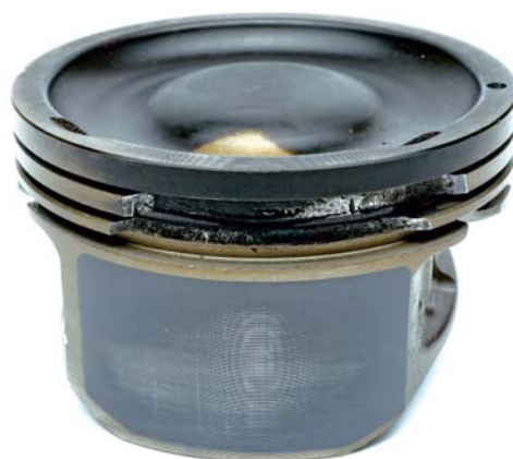
Abb. 1a Gebrochene Kolbenringstege durch Störung im Verbrennungsprozess
