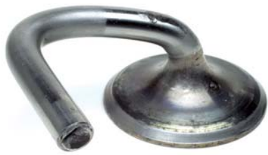
Abb. 1 Stark deformiertes Ventil
