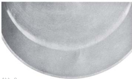
Abb. 2 Glänzende, umlaufende Linie an der Zylinderbohrung
