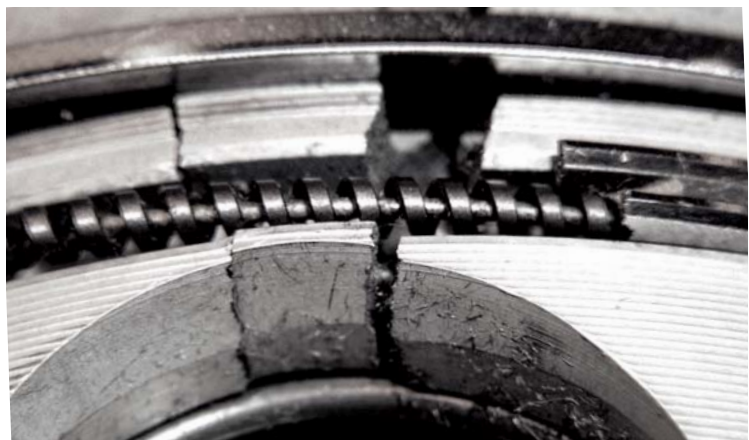
Abb. 3b Nahaufnahme eines Gewaltbruchs
