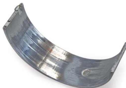
Abb. 2 Ungleichmäßiger Verschleiß an den Lagerschalen
