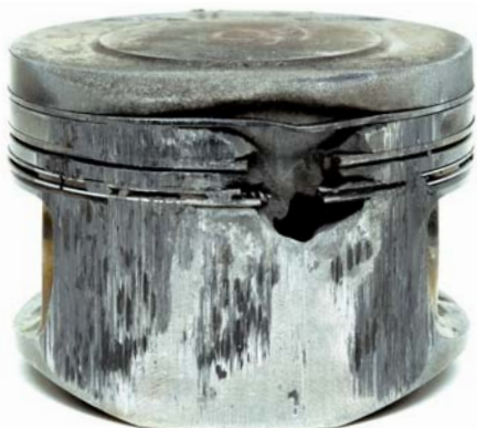
Abb. 4 Durchgeschmolzene Ringzone am Ottokolben
