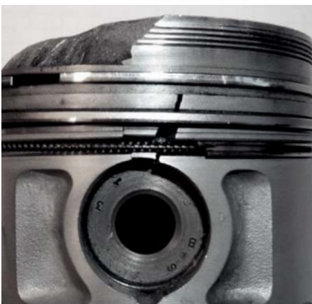
Abb. 3a Gewaltbruch vom Kolbenboden bis zur Nabenbohrung
