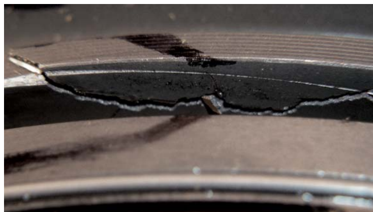
Abb. 3 Montagefehler mit Abdruck des Kolbenrings
