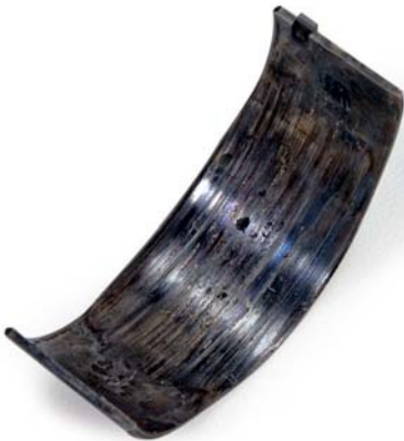
Abb. 2 Stark verschlissenes und ausgeschlagenes Gleitlager
