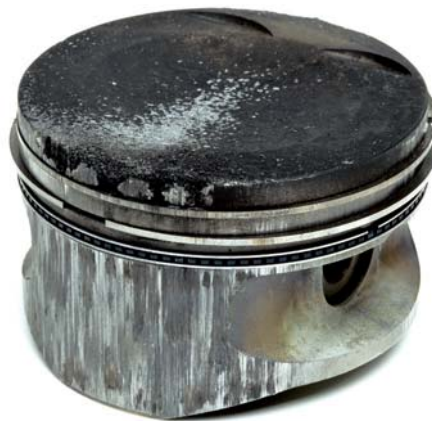
Abb. 3 Starke Erosionsspuren und Abschmelzungen am Kolbenkopf
