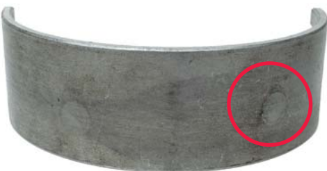
Abb. 4 Verkehrt herum eingebautes Gleitlager – an der Außenseite: Abdrücke der Ölversorgungsbohrungen
