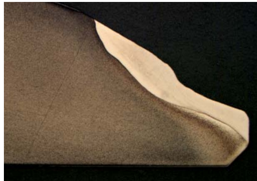
Abb. 3 Extrem abgenutzte Dichtfläche (stellitgepanzert)
