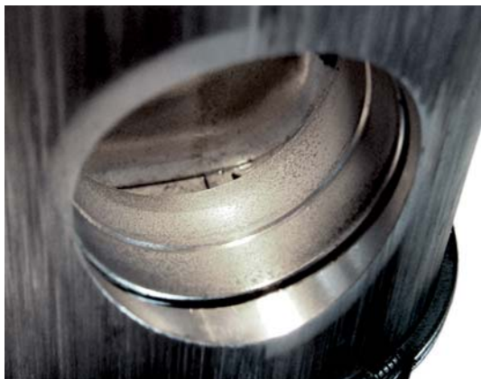
Abb. 4a Pittings in der Nabenbohrung durch verdünntes Motoröl
