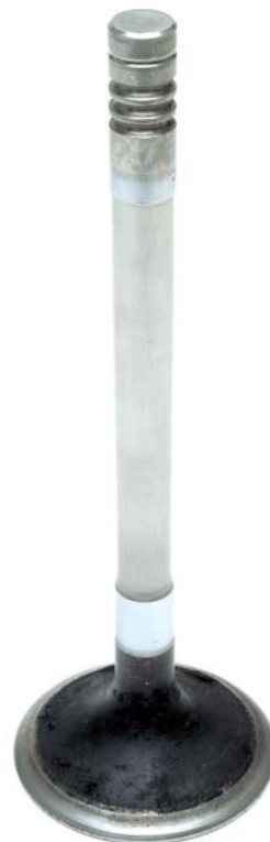
Abb. 7 Stark verschlissener Ventilschaft
