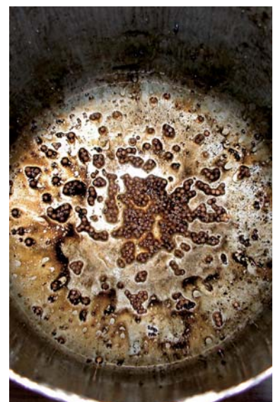
Abb. 3 Granulat, Wasser und Öl in der Lufttrockner-Patrone
