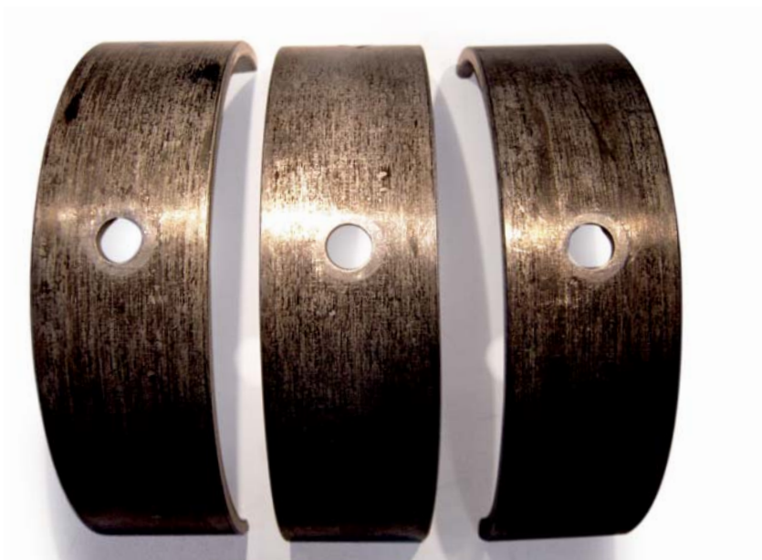
Abb. 1 Polierte Stellen an der Außenseite der Gleitlager
