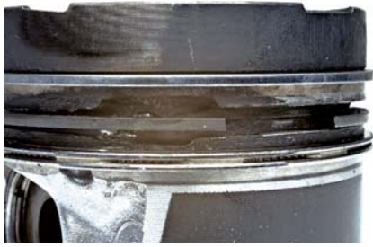
Abb. 1 Stark ausgearbeitete Kolbenringnut
