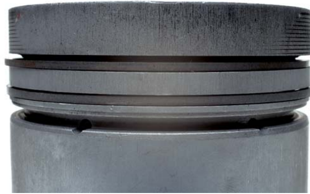
Abb. 4 Axialverschleiß der Kolbenringe
