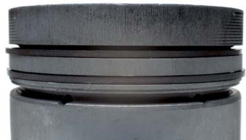
Abb. 2 Starker Axialverschleiß besonders am 1. Kolbenring
