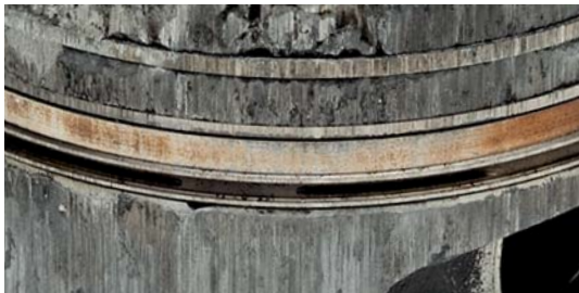
Abb. 2 Riefen und brandige Stellen an Kolbenringen
