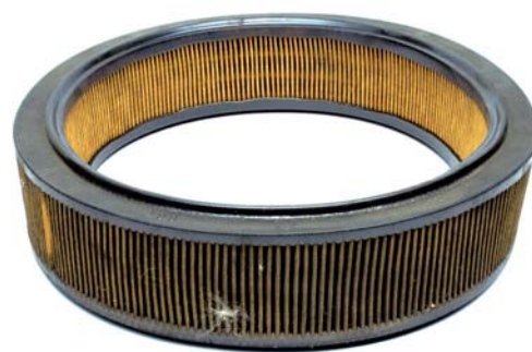
Abb. 3a Stark verschmutzter Luftfiltereinsatz, Wechsel unbedingt erforderlich
