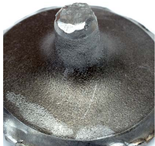
Abb. 3 Schwingungsbruch mit Bruchfläche am Ventilschaft
