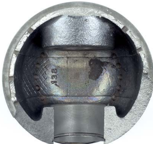
Abb. 3 Quer auf Höhe der Kolbenbolzenachse abgebrochener Kolben
