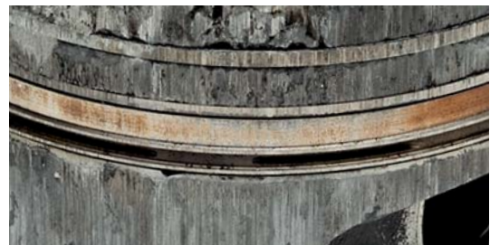
Abb. 2 Riefen und brandige Stellen an Kolbenringen
