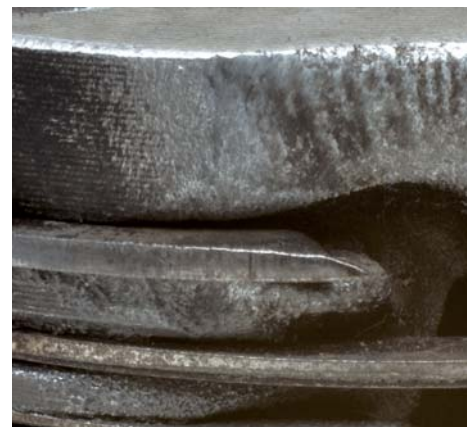
Abb. 1 Erosionsspuren am Ottokolben
