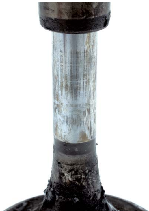
Abb. 1b In der Nahaufnahme deutlich sichtbar: Anhaftungen und Fresser am Ventilschaft
