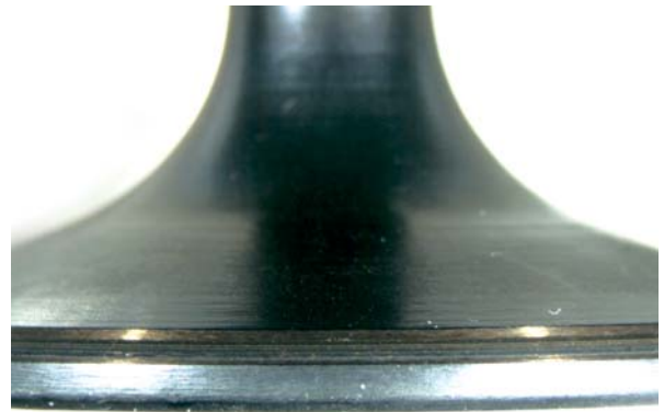
Abb. 2 Zum Vergleich: Ventilteller ohne Verformungen
