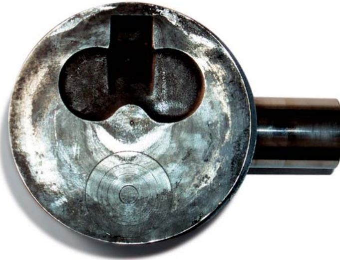
Abb. 1 Kolbenboden mit Ventilaufschlag
