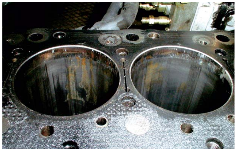
Abb. 2 Zylinderbohrung mit Längsriefen
