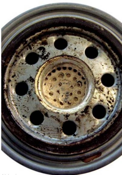
Abb. 1 Granulataustritt aus der Lufttrockner-Patrone
