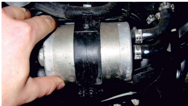
Abb. 6 Kontaktkorrosion aufgrund beschädigter Isolierung
