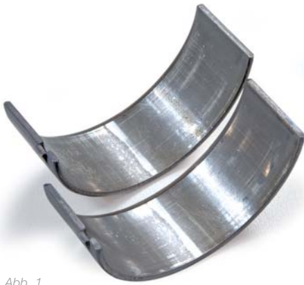
Abb. 1 Glänzende Stellen an den Laufflächen der Lagerschalen
