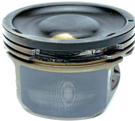
Abb. 2a Gebrochene Kolbenringstege
