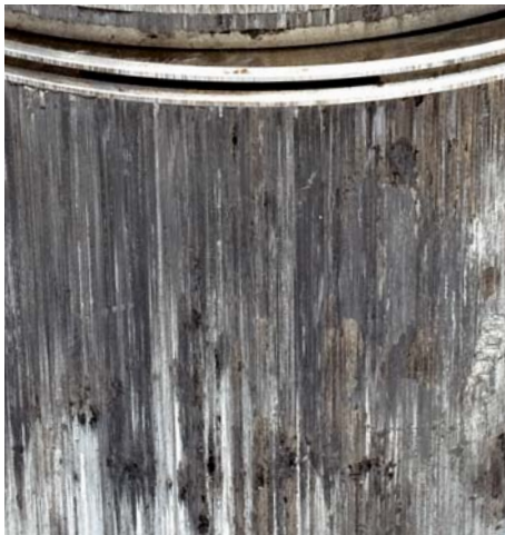
Abb. 1 Einseitiger Fresser auf der Druckseite am Kolbenschaff
