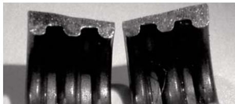
Abb. 3 Deformationen der Ventileile an den Wülsten
