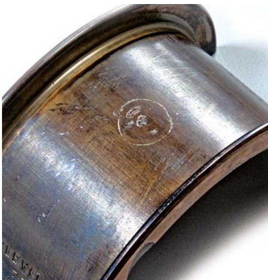
Abb. 2 Fremdkörperabdruck an der Gleitlager-Außenseite
