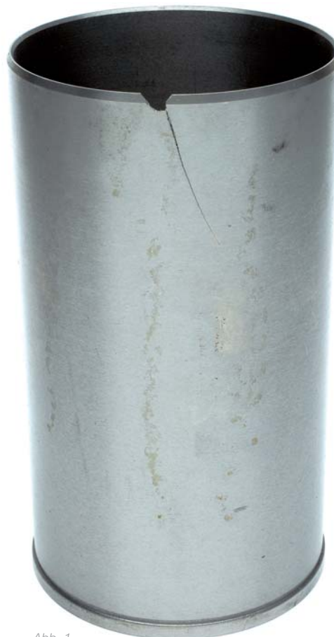
Abb. 1 Unteres Ende der Zylinderlaufbuchse mit Längsris
