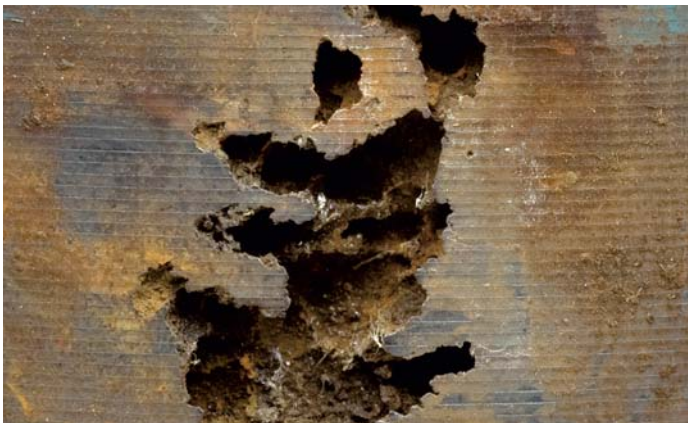
Abb. 1b Nahaufnahme der Zylinderlaufbuchse mit scharfen Kanten und nach innen größer werdenden Löchern
